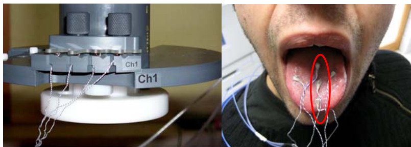
Figura 7: immagine in primo piano del disco e del caricatore con quattro sensori a sinistra, e di cinque sensori EMA incollati sulla lingua di un soggetto prima di un esperimento a destra. Evidenziata dall'ellissi in rosso la collocazione dei sensori da cui sono stati tratti i dati discussi nel paragrafo in 6 (cf. Figure 6-14). Immagini adattate da Tavella, 2007.
